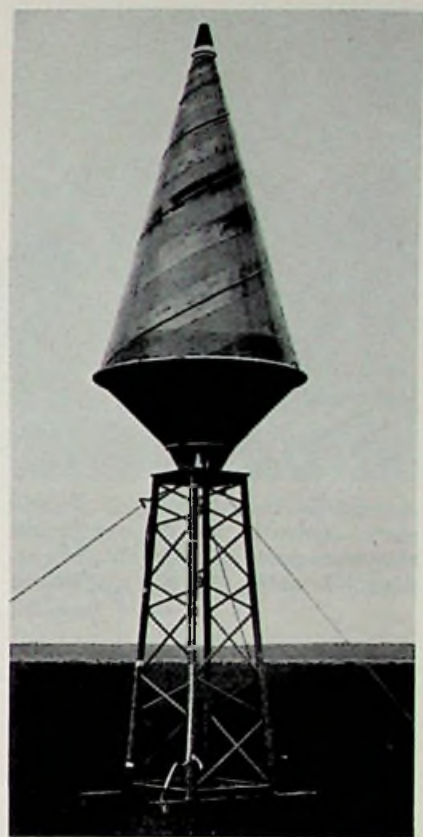
Bild 7. Konische Spiralanterie für Rundempfang
